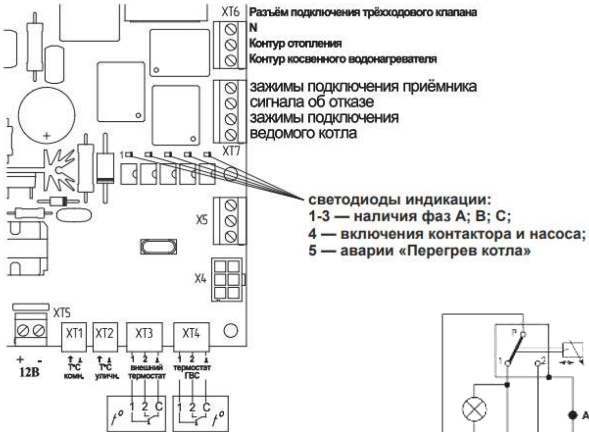
Рис. 1 Схема коммутационной платы котла STOUT.
